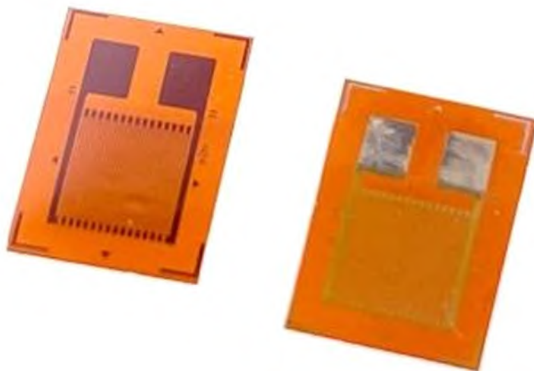
Рис. 2.7. В даній роботі використовувались тензодатчики BF350-3AA [27]
