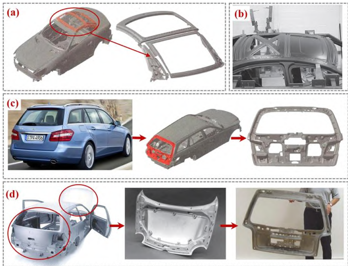
Рис 1. Розробка та застосування Al-Mg сплавів для даху, капота та кришки багажника: (a) складаний дах з магнієвого сплаву для автомобілів Mercedes-Benz серії SL/SLK; (b) внутрішня панель з магнієвого сплаву від Daimler-
