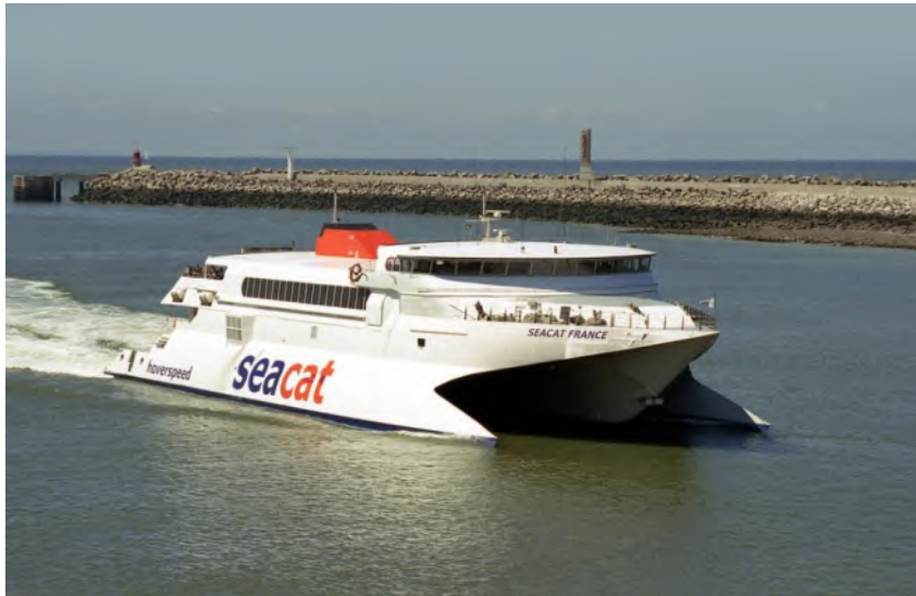
Рис 2. Океанський пором, виготовлений з алюмінієвого сплаву 5xxx серії.
