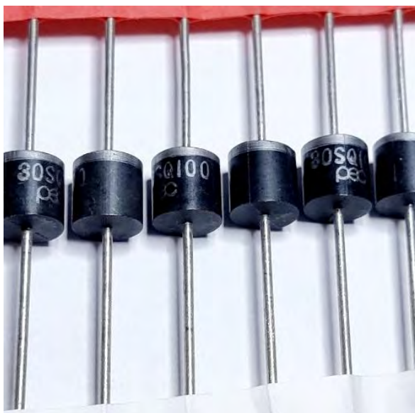
Рис 1.1 Діоди шотткі виготовлені з SiC
